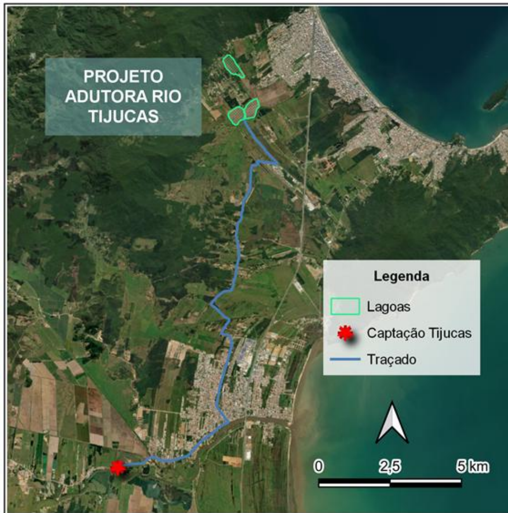
Figura 4 - Traçado previsto para captação, recalque e adução do rio Tijucas.
