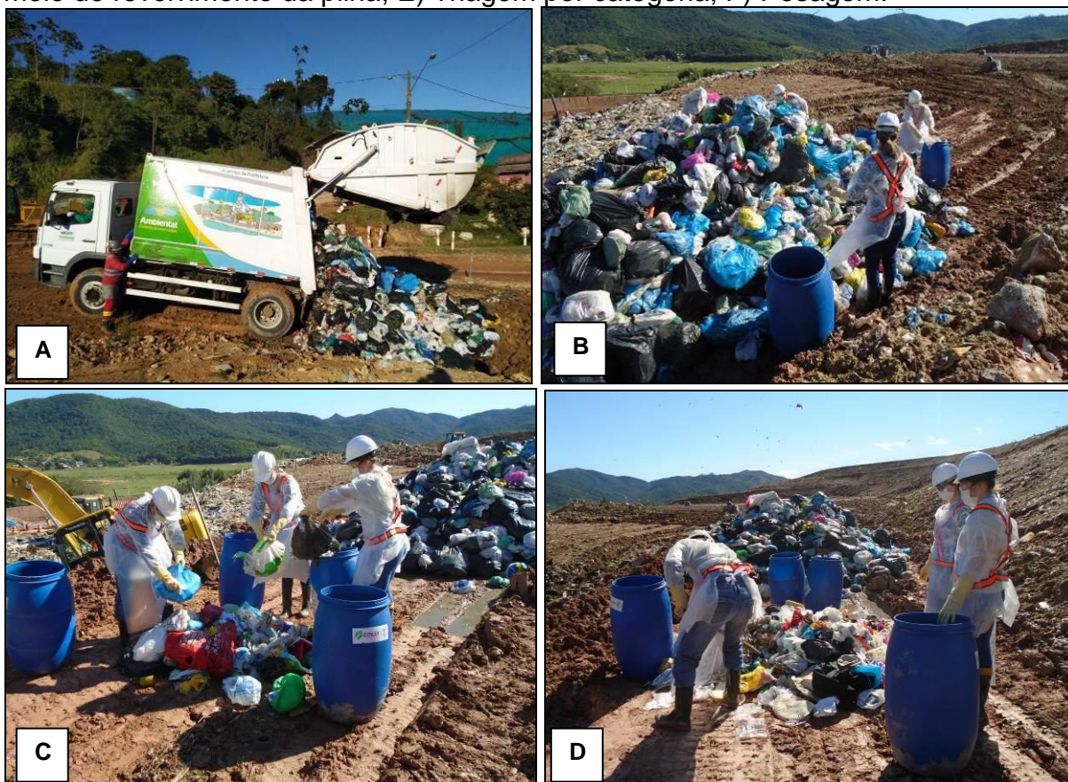
Figura 5 - Composição gravimétrica dos resíduos sólidos da coleta convencional. A) Descarga dos resíduos; B) Amostra retirada da base da pilha; C) Rompimento das sacolas para homogeneização da amostra; D) Homogeneização da amostra por meio de revolvimento da pilha; E) Triagem por categoria; F) Pesagem.
