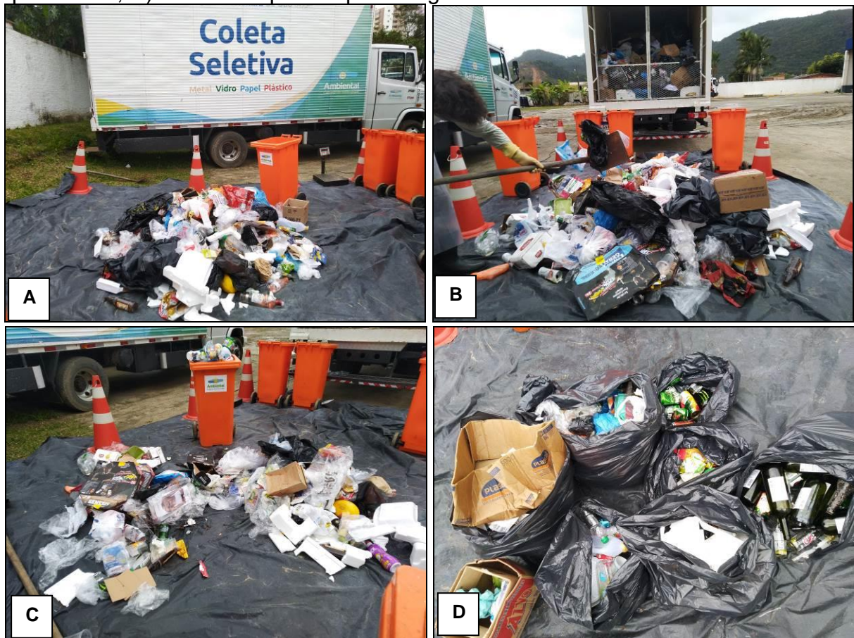
Figura 6 - Composição gravimétrica dos resíduos da coleta seletiva. A) Abertura das sacolas com a amostra; B) Homogeneização da amostra; C) Coleta dos dois quadrantes; D) Material separado por categoria.
