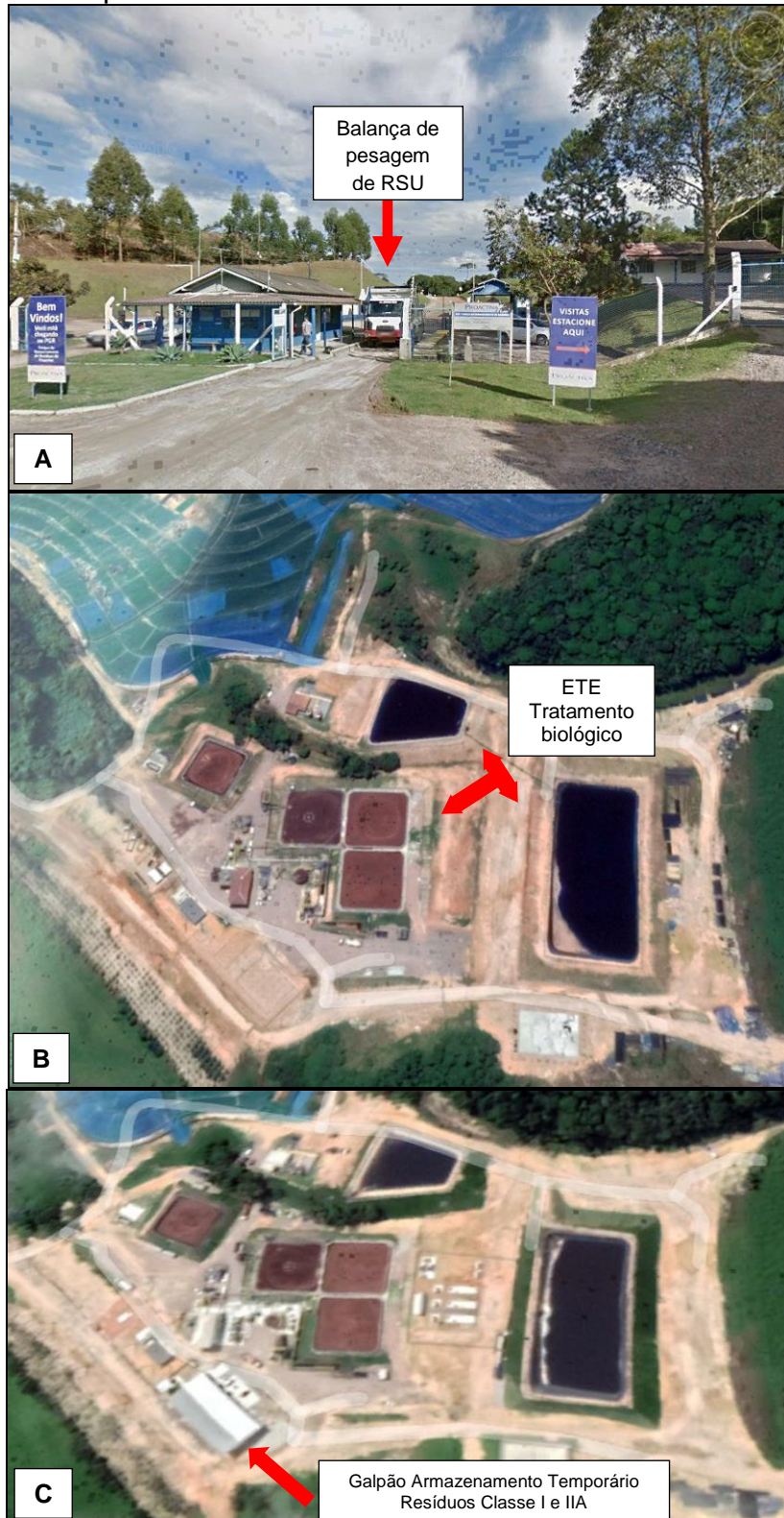
Figura 36 - A) Balança para pesagem dos resíduos no aterro da Proactiva; B) Estação de Tratamento de Efluentes (ETE) - lagoas de tratamento biológico; C) Galpão utilizado para recebimento e desinfecção de resíduos de serviços de saúde e armazenamento temporário de resíduos Classe I e IIA.
