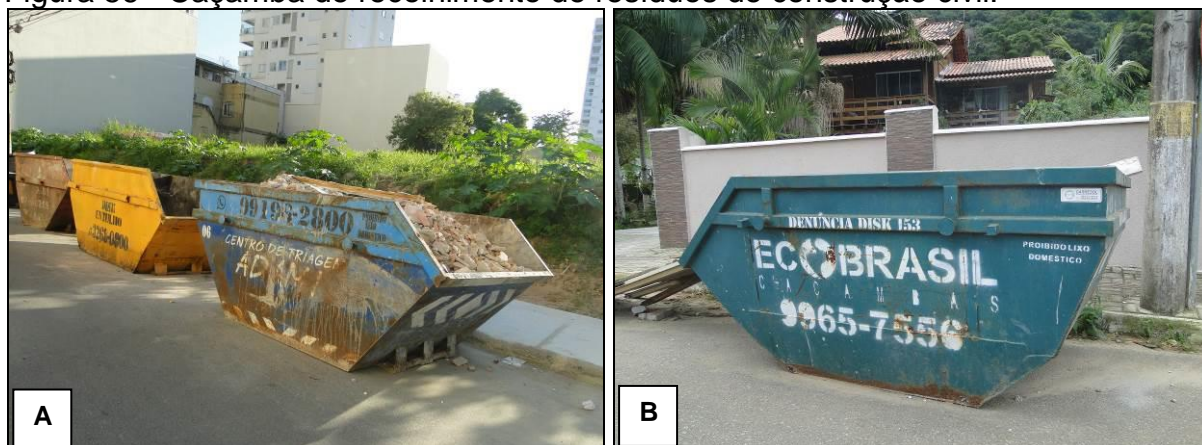
Figura 56 - Caçamba de recolhimento de resíduos de construção civil.
