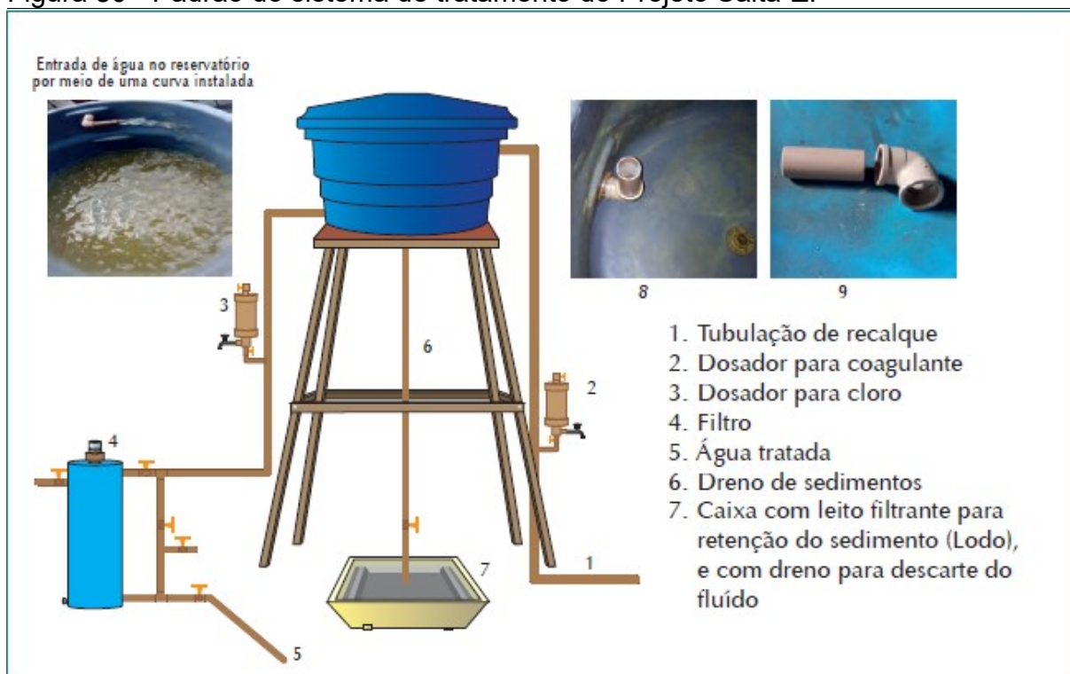
Figura 80 - Padrão do sistema de tratamento do Projeto Salta-Z.
