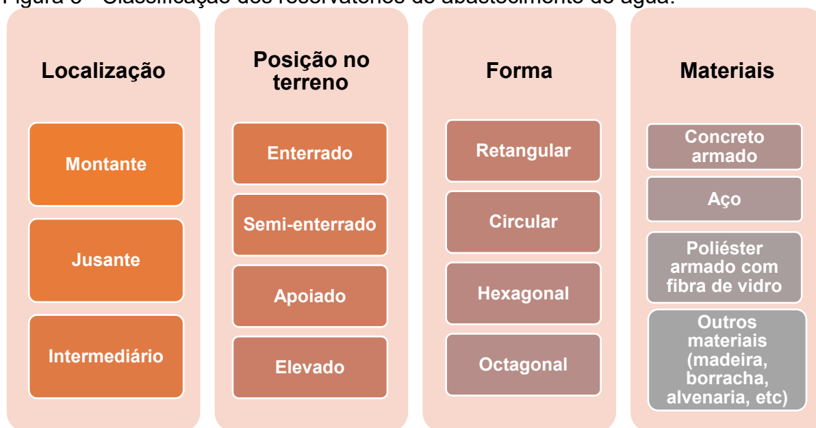
Figura 3 - Classificação dos reservatórios de abastecimento de água.
