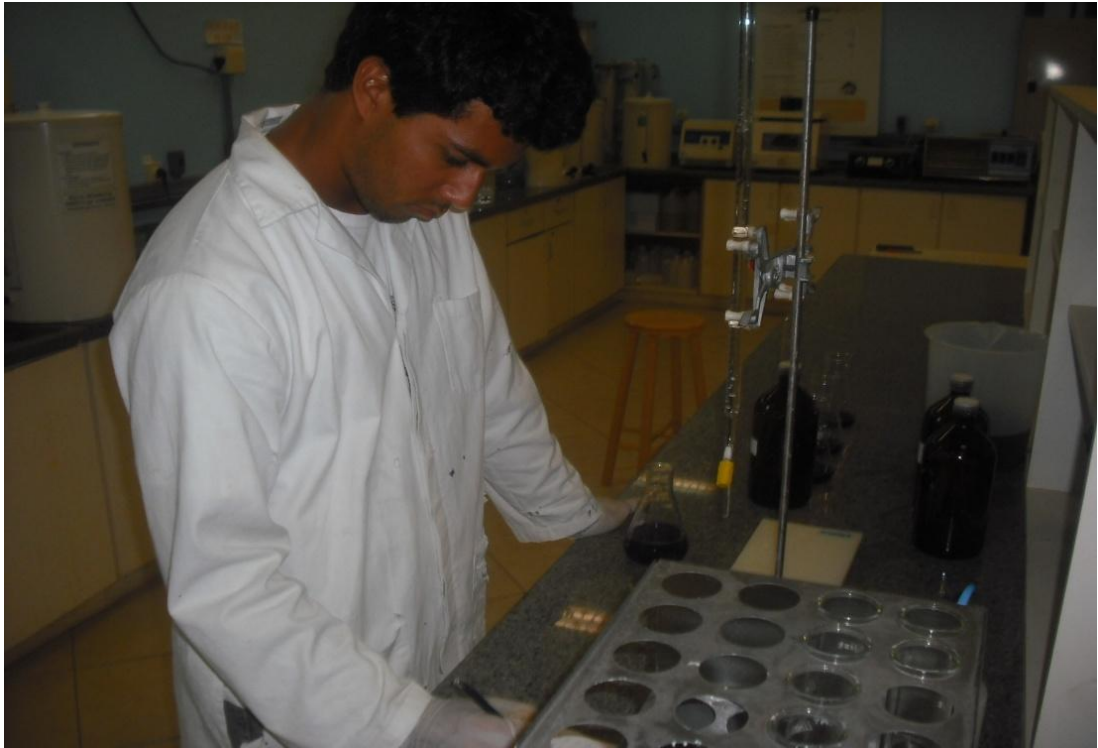
Figura 5 - Titulação do parâmetro Nitrogênio Total Kjeldhal (NTK) no Laboratório Integrado do Meio Ambiente (LIMA). Fonte: NEAmb UFSC, 2009
