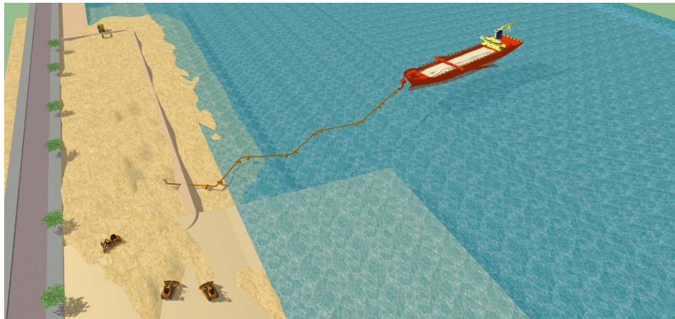
Etapa 3 – Terraplenagem do Aterro Hidráulico.
