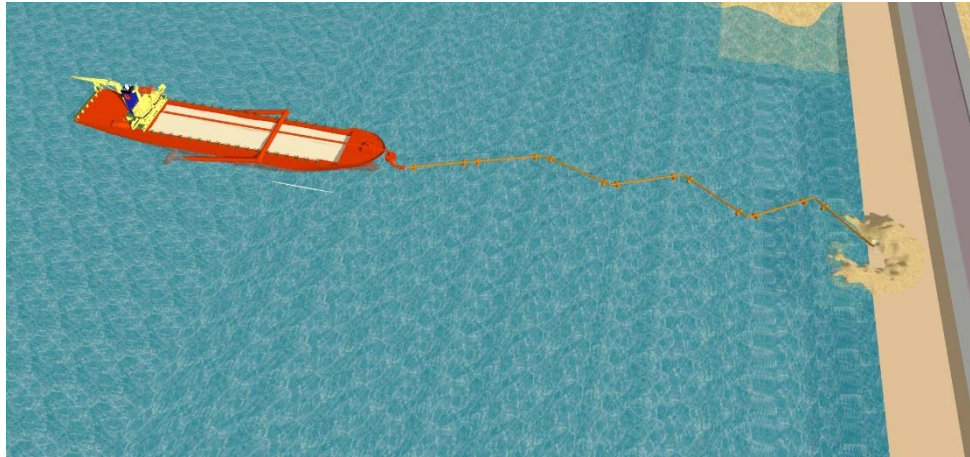
Etapa 1 – Bombeamento para reserva de material na praia.
