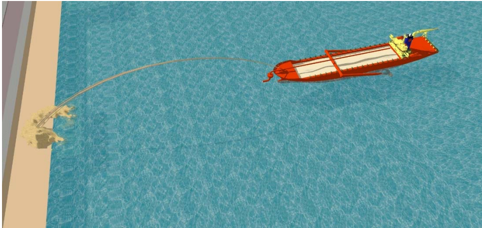
Etapa 1 – Bombeamento para reserva de materia na praia.
